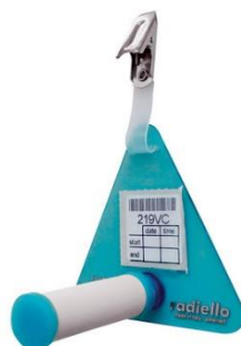
Figure 34 : Photographie d'illustration du tube Radiello dans son corps diffusif, sur support triangulaire
